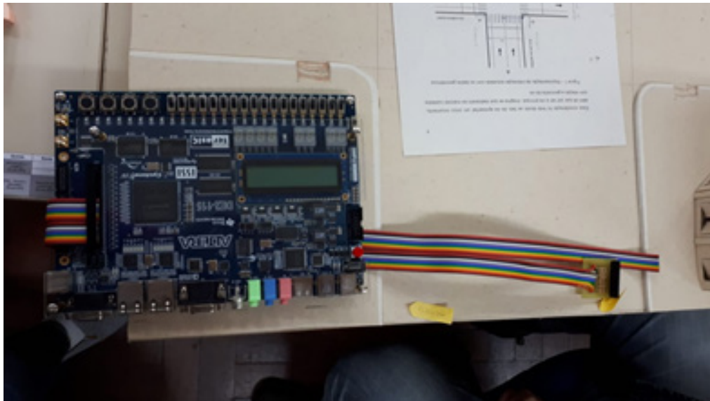
Figura 9 - Registro da Placa de comando dos semáforos com as conexões que foram colocadas abaixo da base da maquete.
