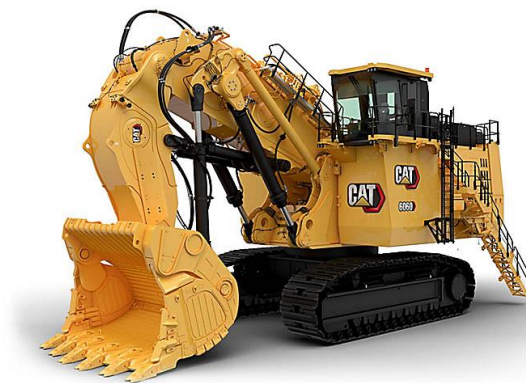
Figura 53 - Escavadeira de caçamba frontal.
