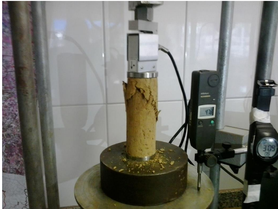
Figura 36 - Ensaio de resistência à compressão simples.
