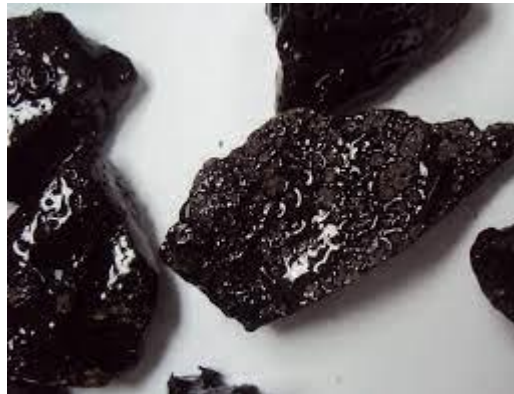
Figura 34 - Ensaio de adesividade.
