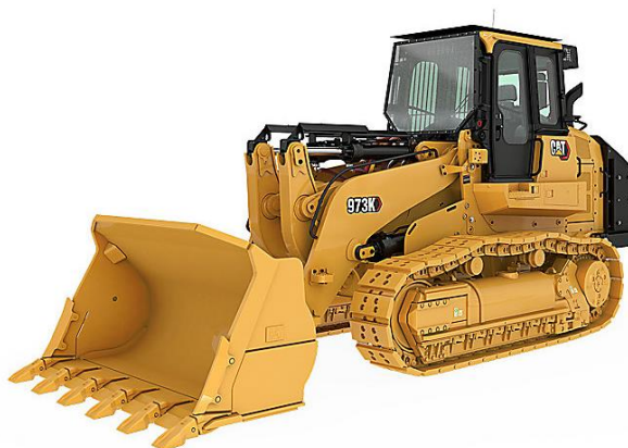
Figura 49 - Carregadeira de esteiras.
