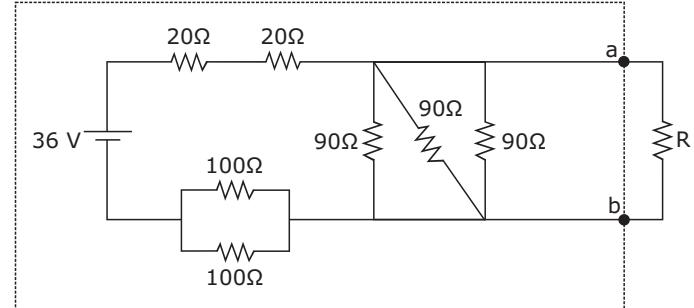
A secção, destacada por pontilhados no circuito, pode ser reduzida por apenas uma fonte de tensão de \_\_\_\_\_ em série com um resistor de \_\_\_\_\_, ou seja, pelo seu Equivalente Thevenin.
