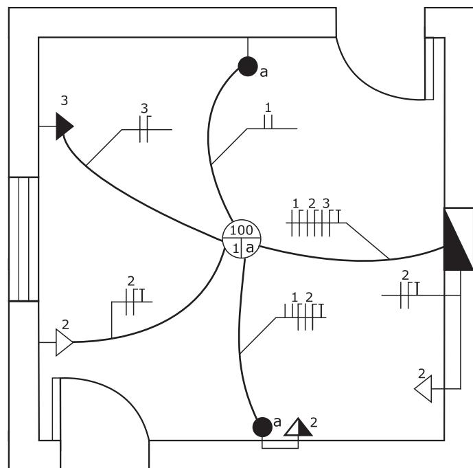
Analizando a ligação elétrica do Circuito 1 (iluminação com interruptor paralelo), do Circuito 2 (tomas) e Circuito 3 (tomada), é correto afirmar que
