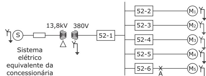
Qual será a máxima corrente simétrica RMS que passará pelo disjuntor 52-6 após um curto-círcuito no trifásico no ponto A?
