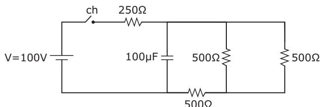
A chave "ch" é fechada no tempo  $t=0$  s. Qual é o valor da carga elétrica, armazenada no capacitor, quando o circuito atingir o regime permanente?
