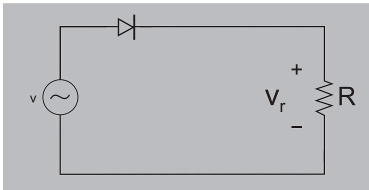
A tensão da fonte é  $v = V \operatorname{sen}(120\pi t)$ . Com respeito a esse circuito, a tensão no resistor, no intervalo de tempo correspondente ao primeiro ciclo da tensão da fonte, é descrita corretamente por
