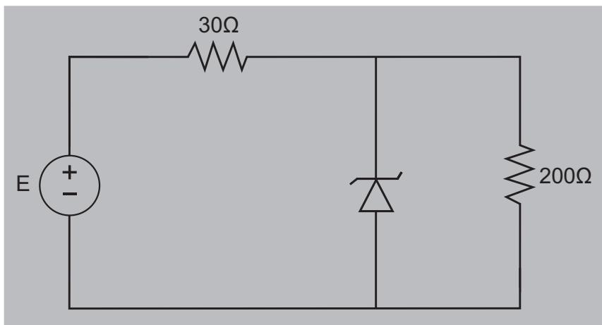
O diodo zener tem uma tensão reversa de ruptura de 10 V e sua potência é de 1 W. Na faixa de operação como regulador de tensão, a corrente no diodo zener só pode variar entre o valor máximo, associado a sua potência, e um valor correspondente a 10% do valor máximo. A partir dessas informações, pode-se determinar que, para o funcionamento adequado do circuito como regulador de tensão, a faixa de valores da tensão de entrada deve ser de
