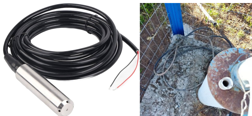
Figura 6 – Sonda de nível aplicada em tubulação de inspeção de nível de poço.
