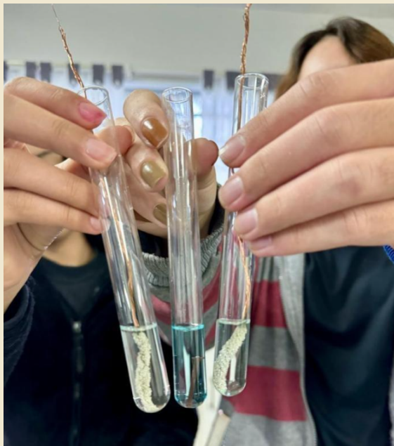
FIGURA 2 – UTILIZAÇÃO DE COBRE METÁLICO E FERRO METÁLICO EM SOLUÇÕES DE SULFATO DE COBRE E NITRATO DE PRATA
