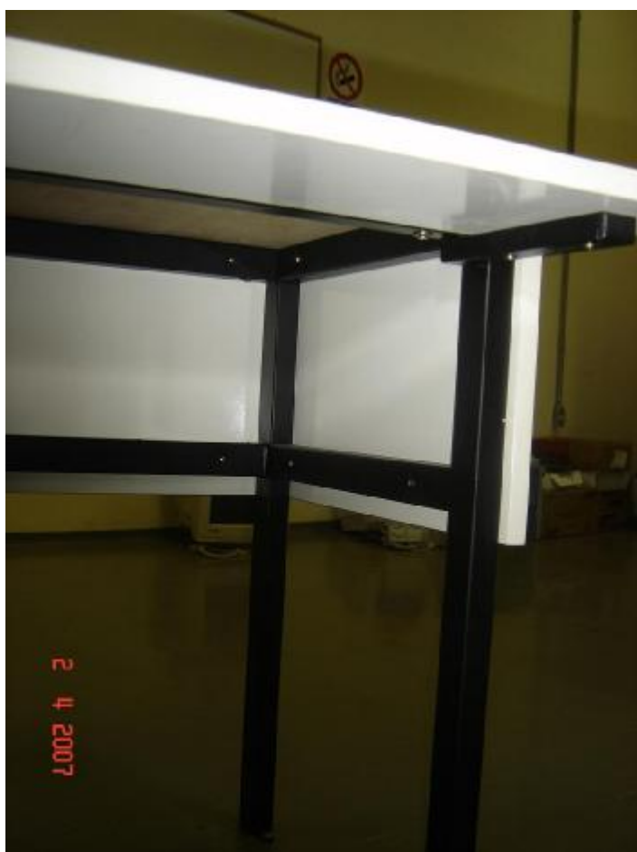
Foto 4: Detalhe da estrutura metálica de suporte ao tampão superior e ao tampão para teclado.
