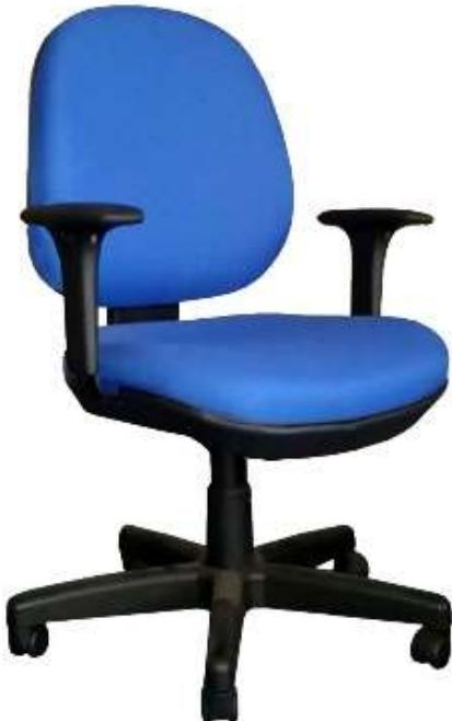
Encosto: Estrutura do encosto médio em chassi confeccionado em polipropileno injetado estrutural de grande resistência mecânica conformado anatomicamente, provida de superfície estofada em espuma injetada de 60 mm de espessura média, densidade 50kg/m3. Haste de ligação ao assento através de lâmina de aço com 80 mm de largura x 6,35 mm de espessura. Carenagem em polipropileno texturizado preto que dispensam o uso de perfil
