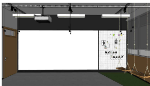
Figura 9 – Lousa em MDF cru, revestida com laminado de formica branca, conforme indicações de projeto.
