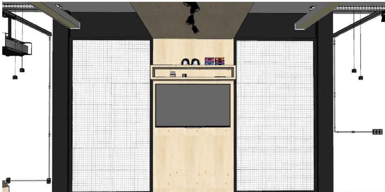
Figura 5 – Revestimento e nicho em compensado de virola, conforme dimensões indicadas em projeto
