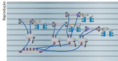
Circuito de pneumática montado no simulador.
