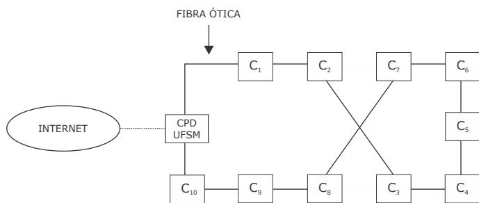
O CPD está conectado à Internet por um *link* de alta velocidade. Cada centro está conectado ao próximo por um cabo de fibra ótica. Qualquer comunicação que chega da Internet é repassada pela rede ao C1, que repassa ao C2 e assim sucessivamente, até atingir o destino, ou retornar ao CPD, via C10. Neste caso, o destinatário não existe ou não está disponível.
