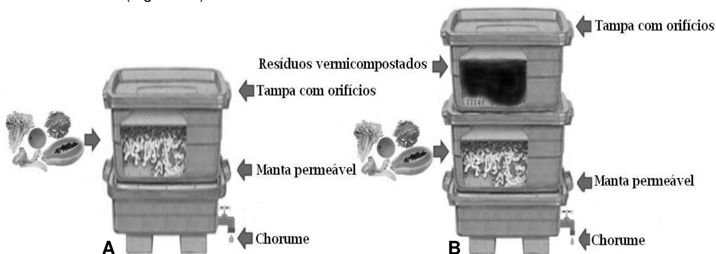
Figura 1: Manejo dos resíduos orgânicos nas unidades de vermicompostagem caseira (UVC). (Adaptado de LEGAN, 2008).
