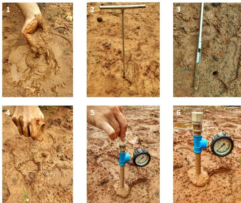
Figura 5: Passos para a instalação do tensiômetro. Fonte: Arquivo pessoal (2016).
