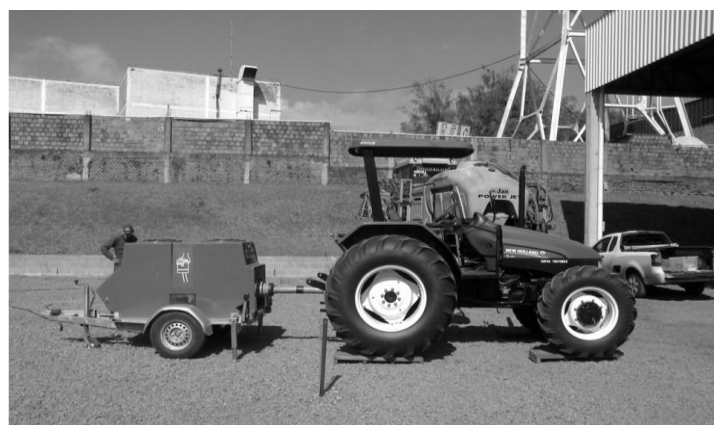
Figura 4 - Avaliação do desempenho de um motor, utilizando o dinamômetro móvel disponível no Laboratório de Agrotecnologia (Agrotec/NEMA) da UFSM
