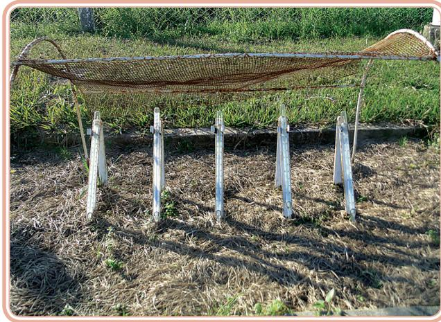
**Figura 5.5: Bateria de geotermômetros instalados a várias profundidades em solo com vegetação e com cobertura na estação meteorológica da UFSM**
