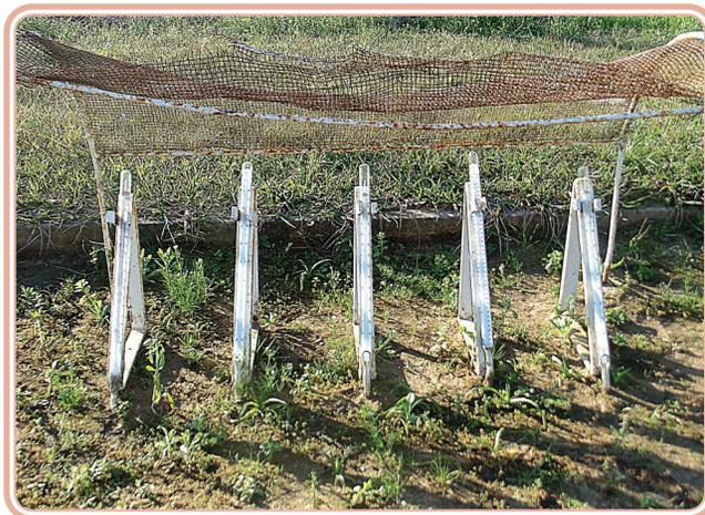
**Figura 5.6: Bateria de geotermômetros instalados a várias profundidades em solo desnudo e com cobertura na estação meteorológica da UFSM**
