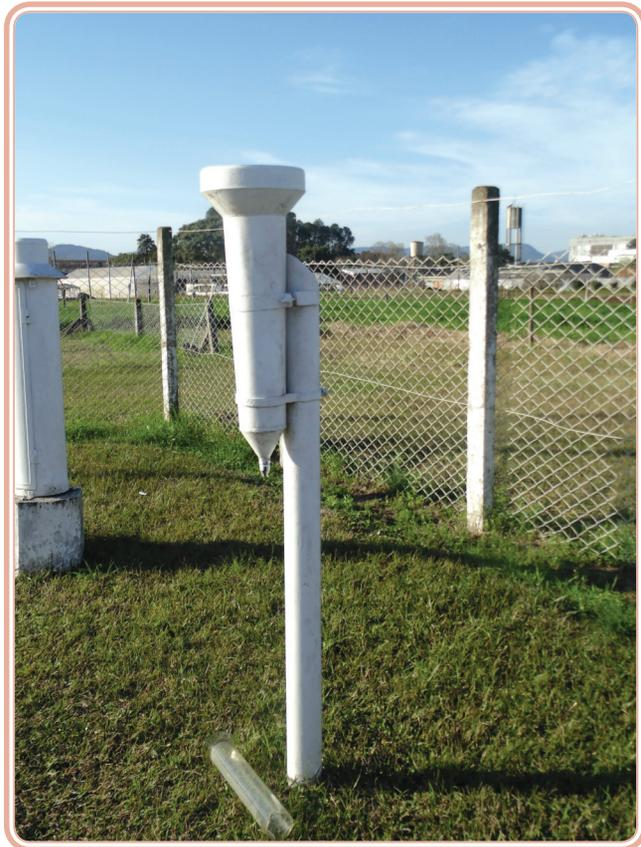
**Figura 5.13: Detalhe ilustrativo do pluviômetro e pluviógrafo instalados na estação meteorológica da UFSM**
