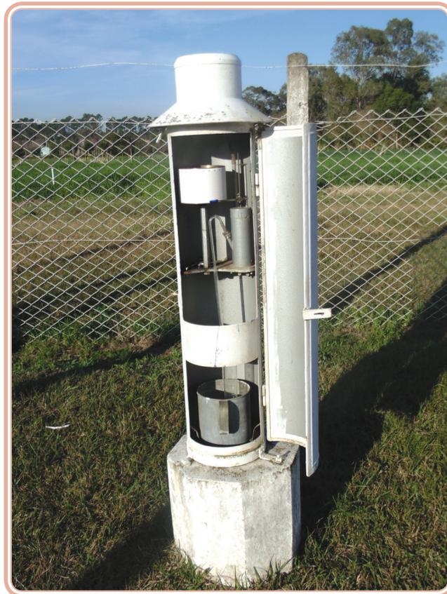
**Figura 5.12: Pluviógrafo na estação meteorológica da UFSM**
