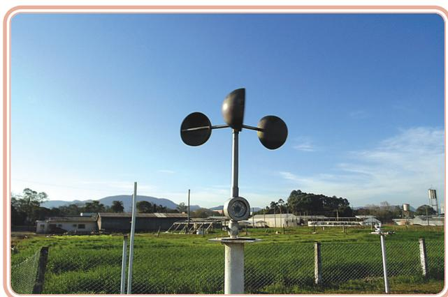
**Figura 5.9: Anemômetro de canecas na estação meteorológica da UFSM**
