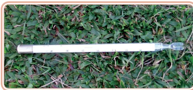
**Figura 5.3: Termômetro de relva na estação meteorológica da UFSM**
