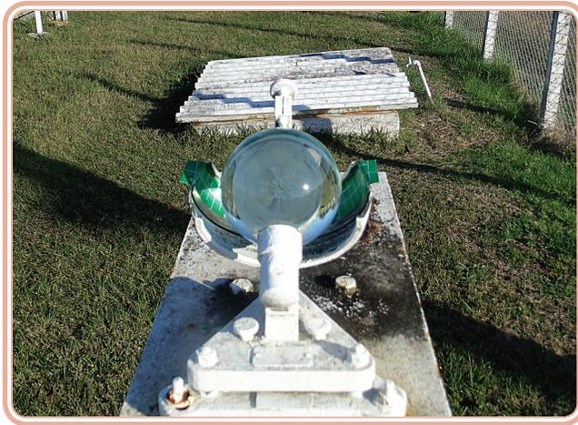
**Figura 5.7: Heliógrafo na estação meteorológica da UFSM**
