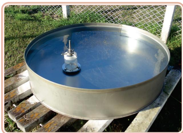
**Figura 5.8: Tanques de evaporação classe A na estação meteorológica da UFSM**
