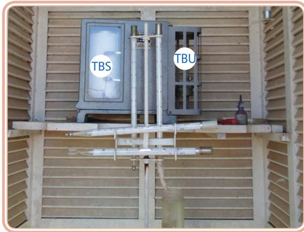
**Figura 5.11: Os dois termômetros em pé (na vertical) compõem o psicrômetro na estação meteorológica da UFSM**
