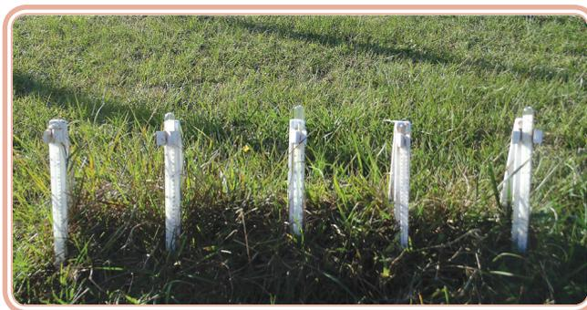
**Figura 5.4: Bateria de geotermômetros instalados a várias profundidades em solo com vegetação e sem cobertura na estação meteorológica da UFSM**
