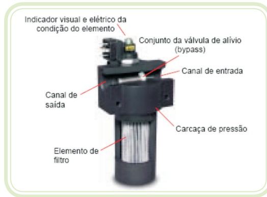
Figura 8.25: Filtro de pressão em corte
