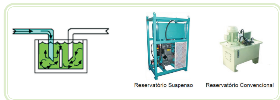
Figura 8.15: Separação de gases e impurezas no reservatório da unidade hidráulica
