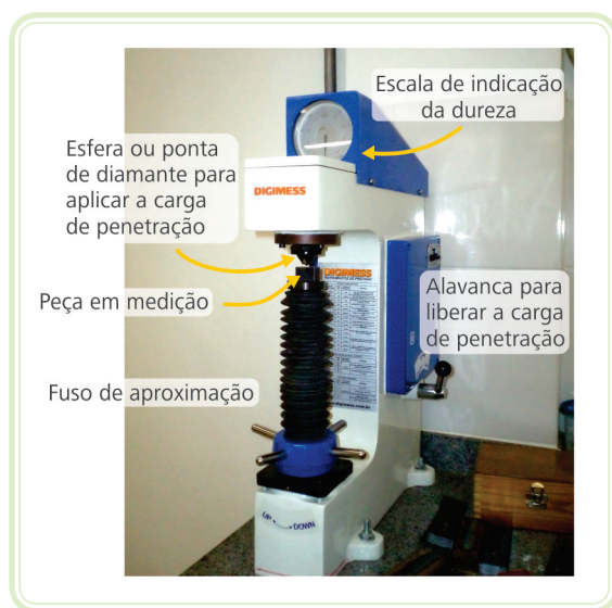
Figura 2.7: Durômetro usado para realizar ensaios de dureza Rockwell B e C Fonte: CTISM, adaptado dos autores
