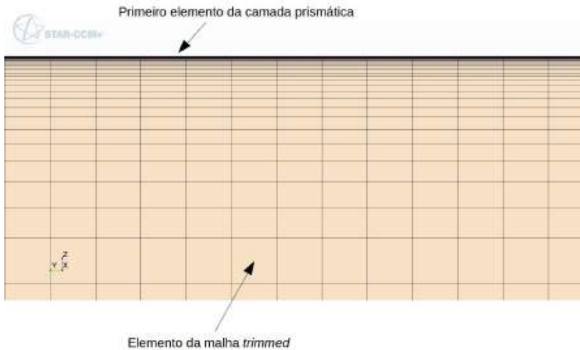
Figura 6.16 – Crescimento das camadas prismáticas. Fonte: Autor
