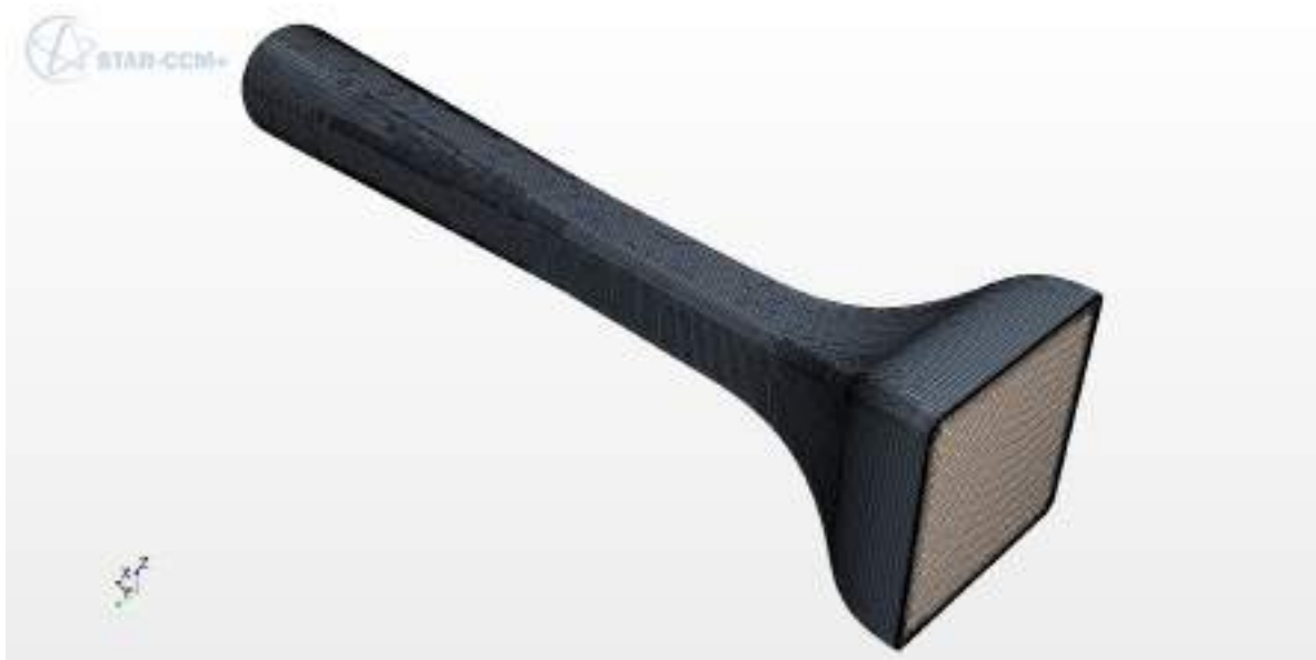
Figura 6.14 – Malha trimmed gerada na geometria do túnel de vento. Fonte: Autor
