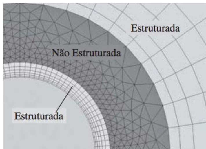
Figura 6.5 – Exemplo de malha híbrida. Fonte: Çengel e M.Cimbala (2015)
