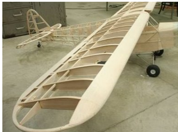
Figura 4.41 – Aeromodelo feito em madeira balsa.
