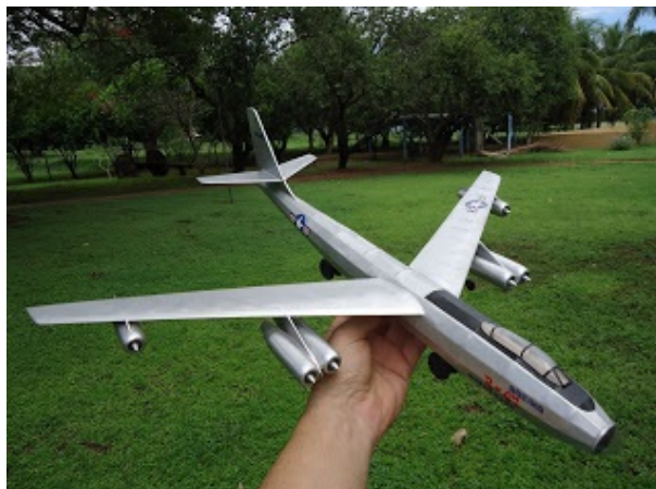
Figura 4.45 – Aeromodelo pintado com tinta spray.
