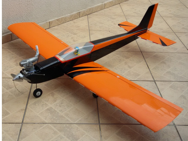
Figura 4.42 – Aeromodelo entelado com monokote.
