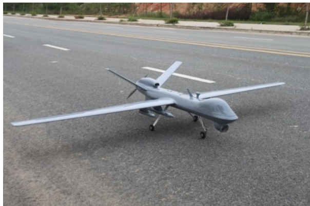
Figura 4.38 – VANT com estrutura em fibra de vidro.
