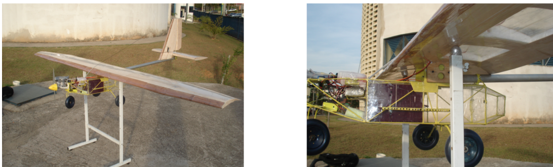
Figura 4.67 – Localização do CG em um aeromodelo.
