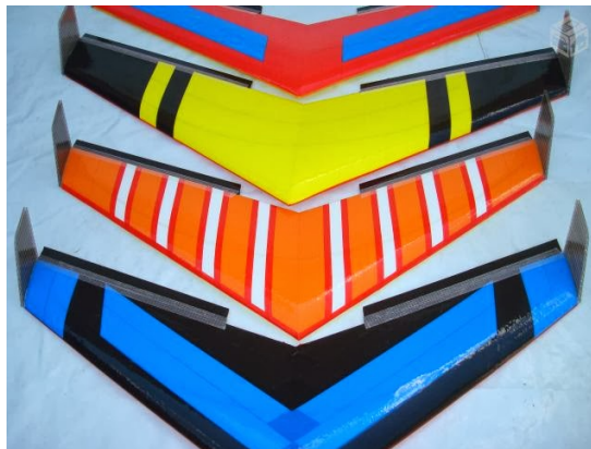
Figura 4.44 – Asas voadoras enteladas com fita colorida.
