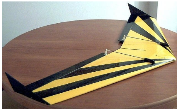
Figura 4.40 – Asa voadora com estrutura em depron e fibra de vidro.
