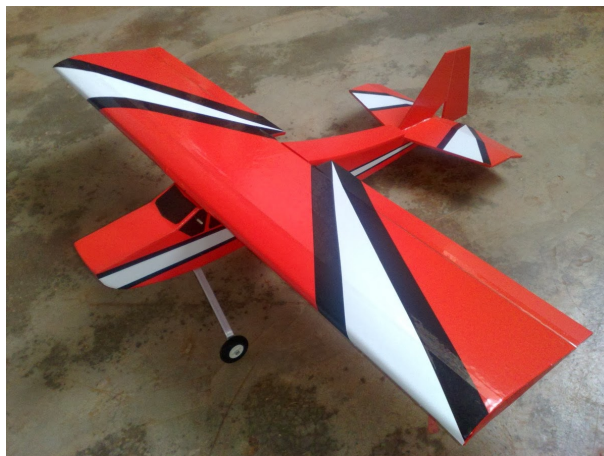
Figura 4.43 – Aeromodelo entelado com vinil adesivo.
