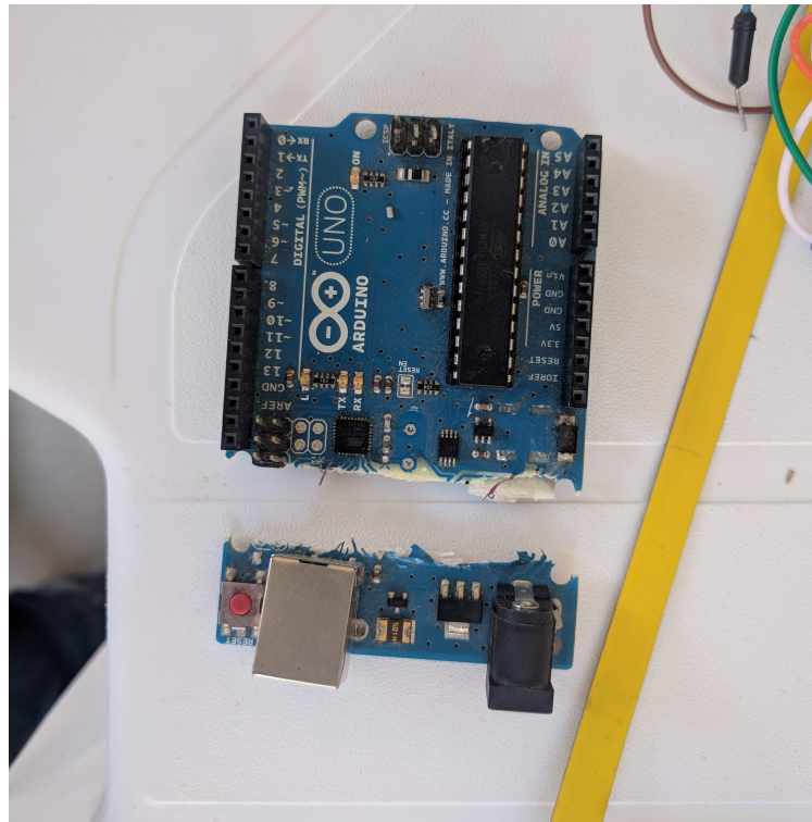
Figura 7.2 – Arduino UNO danificado após o segundo lançamento.
