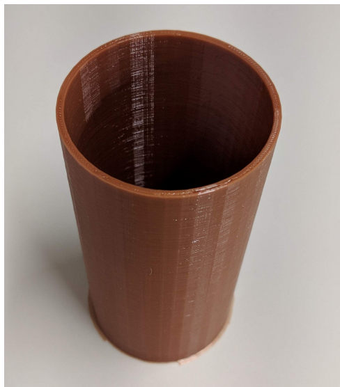
Figura 6.3 – Estrutura externa em PLA.
