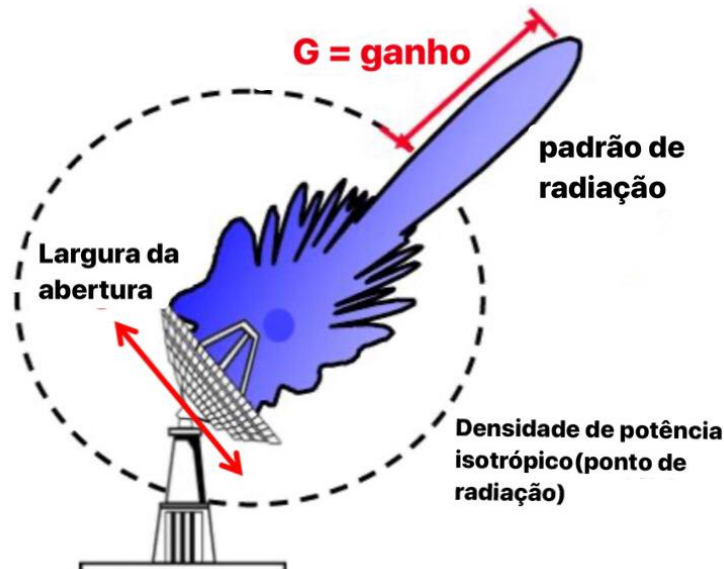
Figura 4.2 – Funcionamento de uma antena.(Charvat, Gregory et all., 2011)
