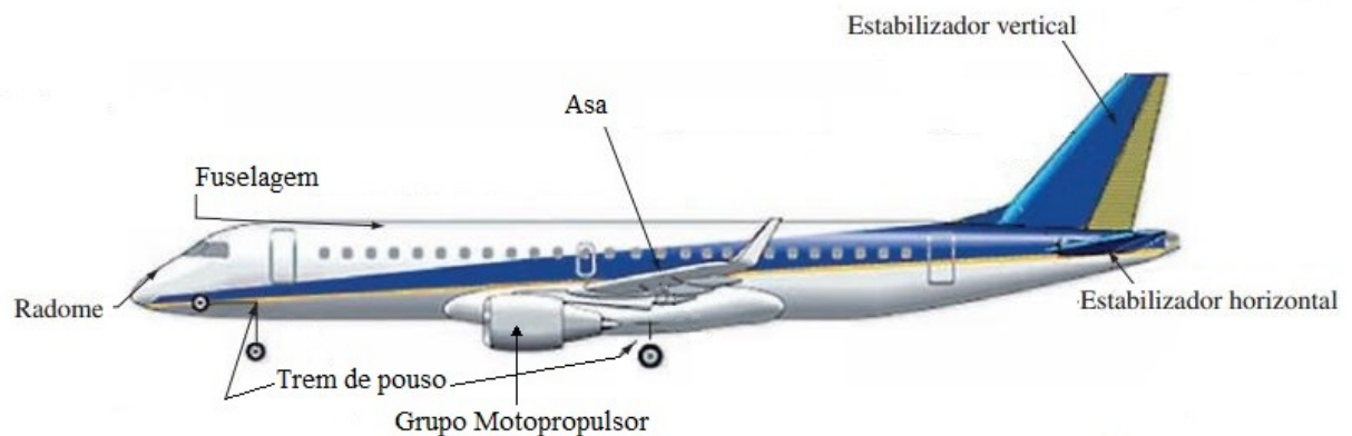
Figura 4.1 – EMB-170 e seus principais componentes
