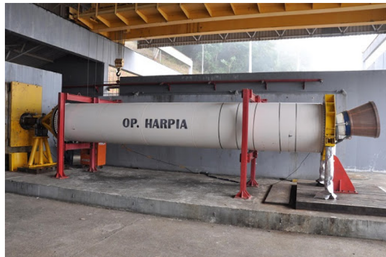
Figura 3.11 – Motor S43 em bancada de testes.
