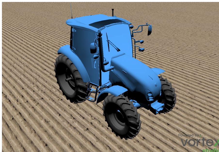
Figura 2.3 – Geometria do trator modelado no Vortex Studio .
