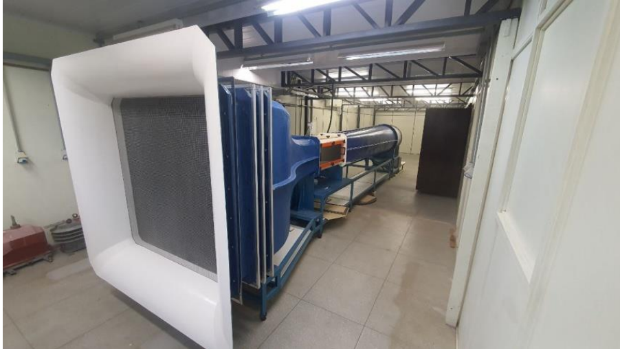
Figura 9 - Túnel de vento para ensaios e testes aerodinâmicos de protótipos.
