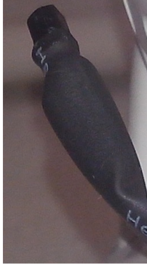
Figura 3.4 – Sensor LM35 com espaguete termoretrátil
