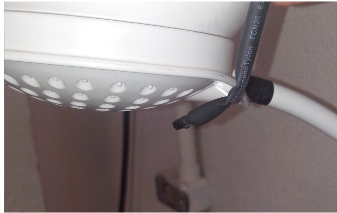
Figura 4.3 – Instalação do sensor de temperatura
