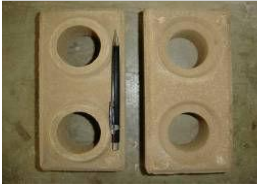
Figura 2 - Tijolos vazados de solo-cimento no formato 19,5x10x5 cm com 2 furos Fonte: LIMA, 2006
