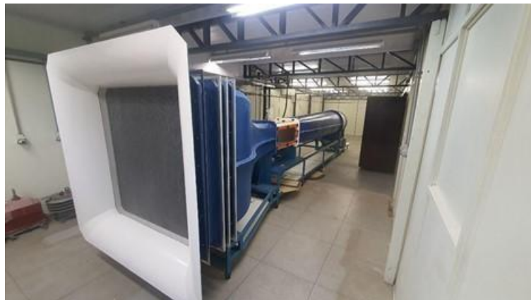
Figura 19 - Túnel de vento para ensaios e testes aerodinâmicos de protótipos.
