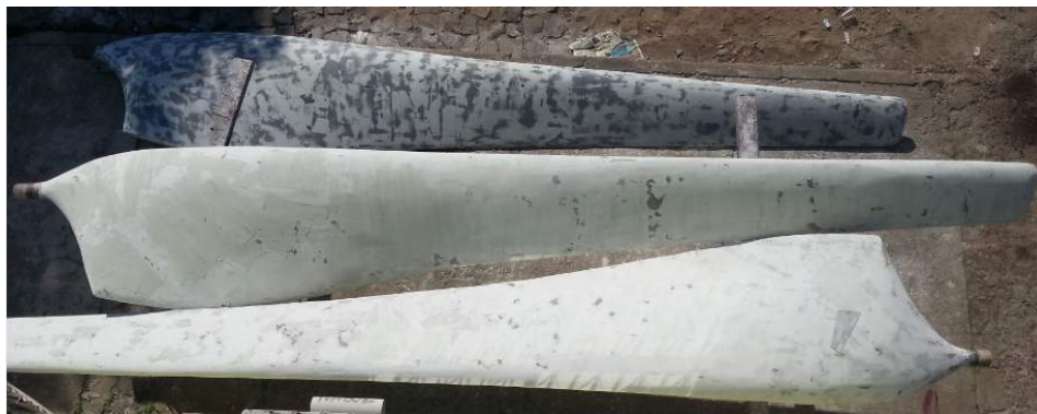
Figura 6: Três hélices no processo de acabamento
