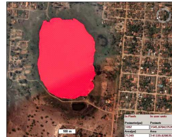
Figura 4.3.2. Imagem de satélite da Lagoa do Meio com a mensuração de área e perímetro, através do Software UDR. Fonte: Org. Basso, mensuração elaborada em Março de 2007.
