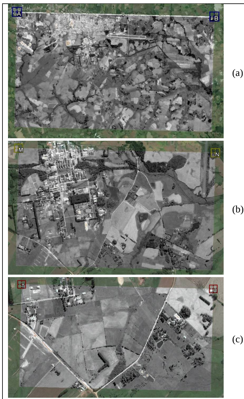
Fig. 6 - Correlação das imagens georreferenciadas com o RapGeo com as imagens bases do Google Earth : análise em três diferentes escalas (a), (b) e (c).
