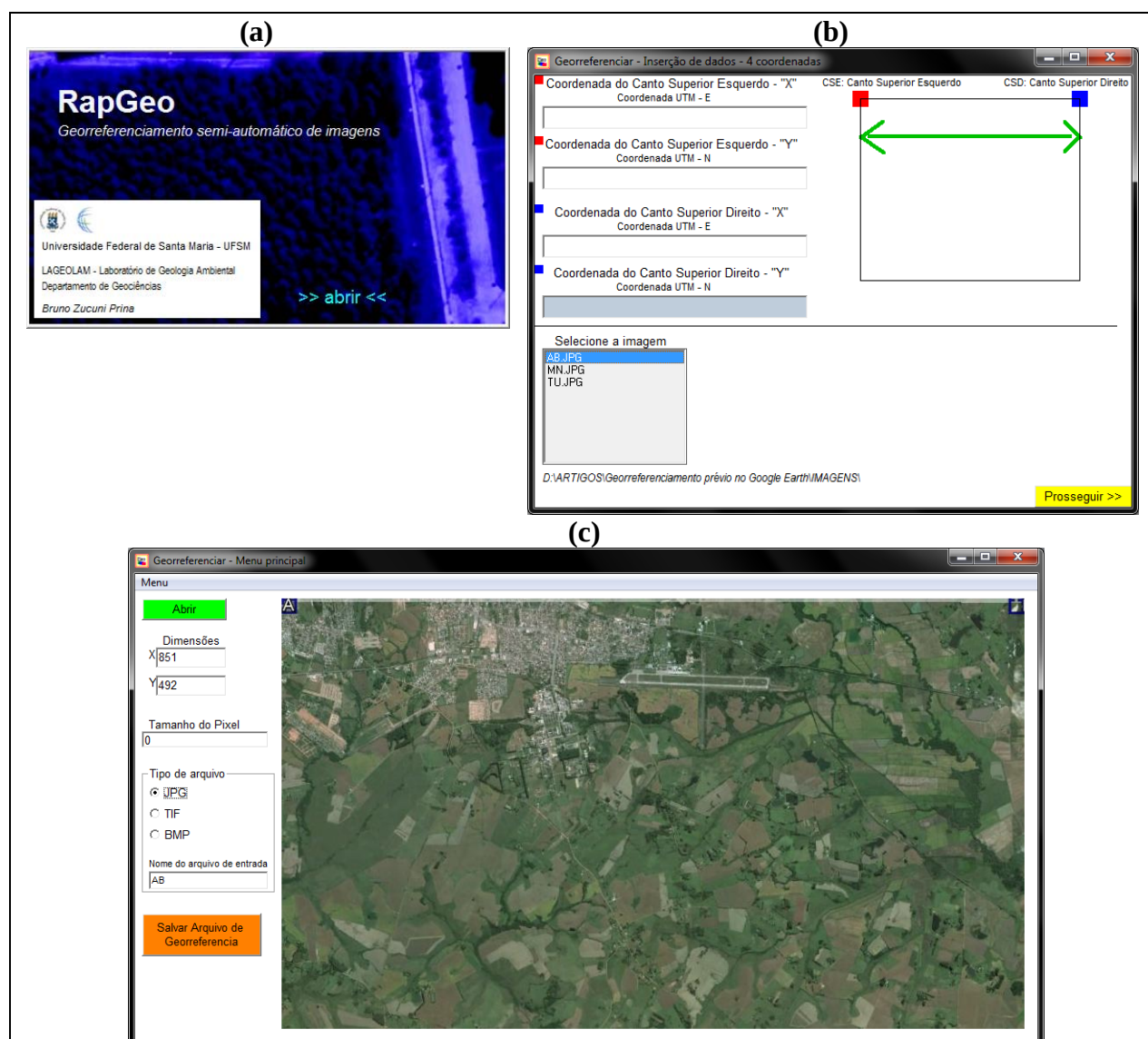
Fig. 5 - Visão do aplicativo RapGeo: tela de entrada (a); inserção dos dados e escolha da imagem (b); Visualização da imagem, juntamente com as informações para salvar o arquivo de georreferência (c).
