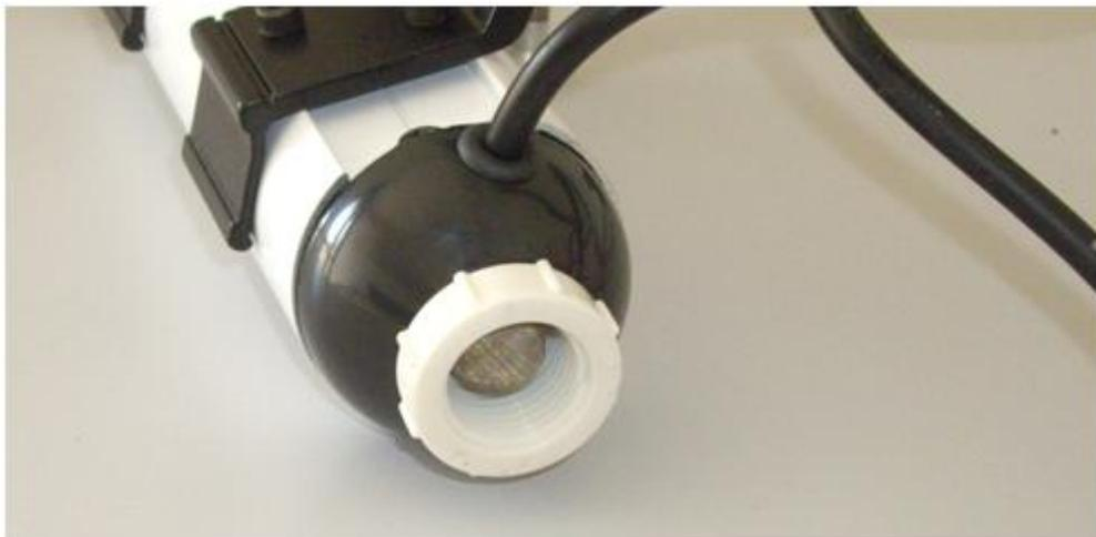
Figura 24 – Vista externa do sensor de gás.
