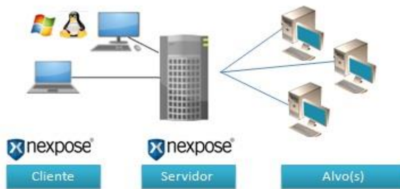
Figura 13: Visão da arquitetura Nexpose.
