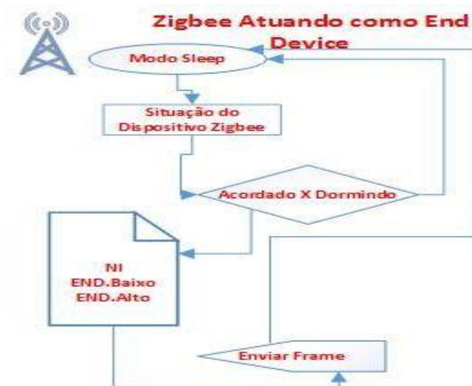
Figura 16 – Diagrama de configuração do dispositivo final em modo sleep
