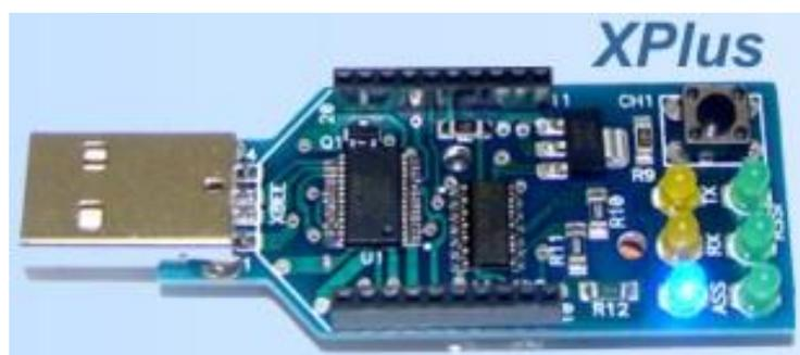
Figura 7 – Módulo de conexão do *XBee/XBee-Pro* com a USB do computador.
