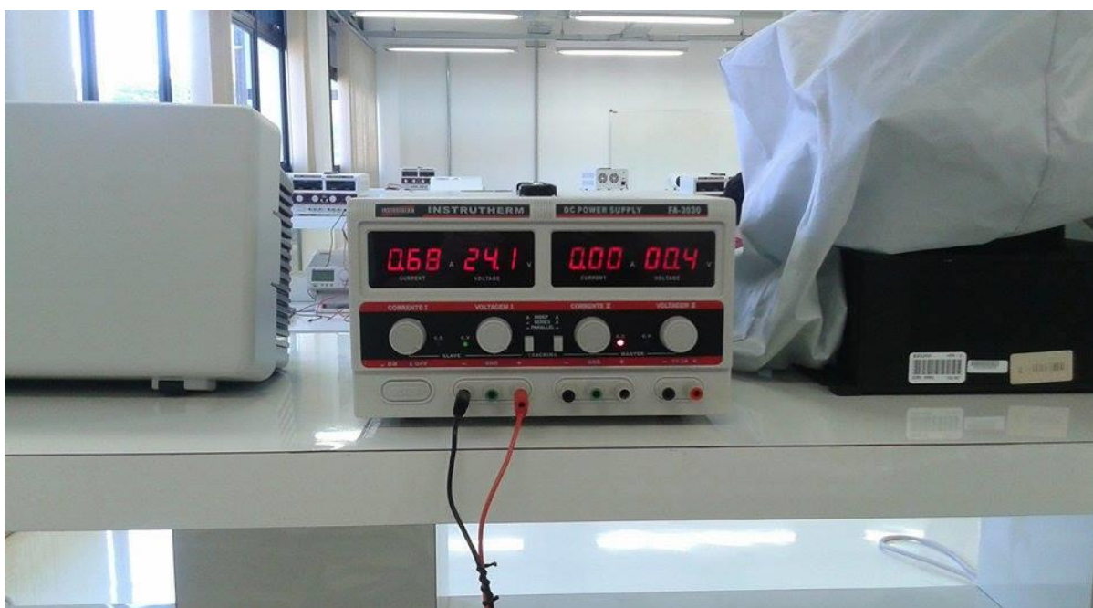
Figura 6 – Fonte de alimentação do leitor, com 24 Volts .
