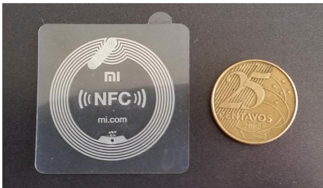
Figura 6 – Comparação das dimensões do *tag* NFC utilizado e uma moeda
