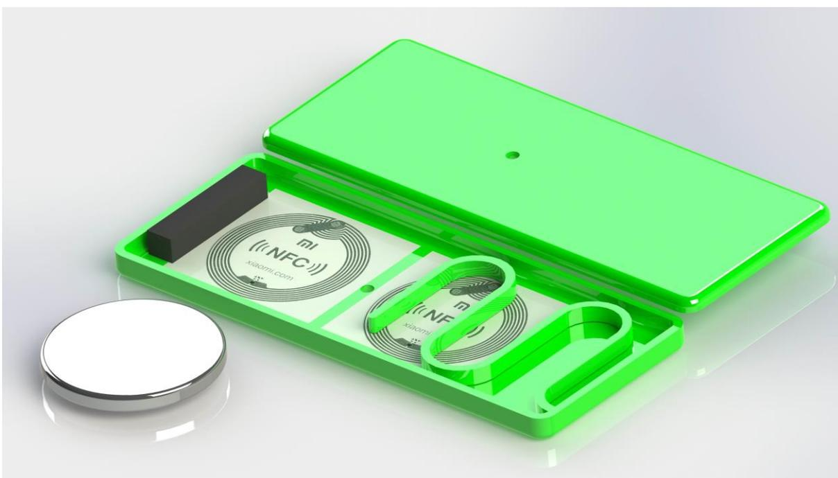
Figura 8 – Projeto em CAD do invólucro do sensor de violação de bagagem
