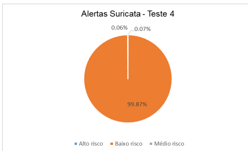
Figura 25: Categoria dos alertas gerados pelo Suricata após a reprodução do Pacote 2 a 1000 MBit/s.
