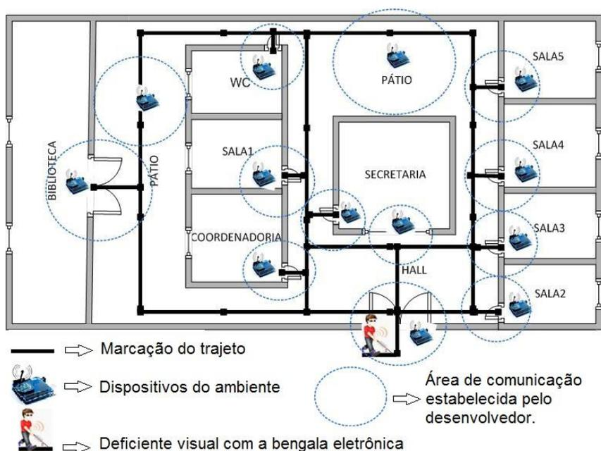
Figura 36. Modelo representativo da configuração do projeto.
