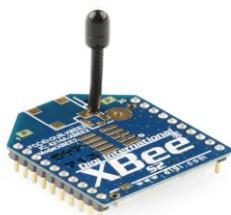
Figura 37. Módulo XBee 802.15.4 (Serie 2).
