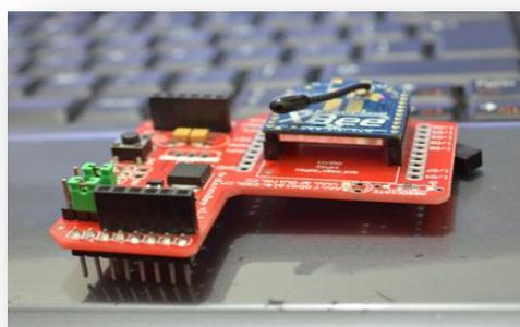
Figura 23. Shield XBee para Arduino.
