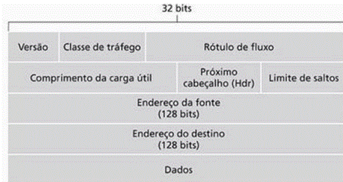
Figura 12: Formato básico do datagrama IPv6. Fonte: Kurose; Ross. Redes de computadores e a Internet (2010).
