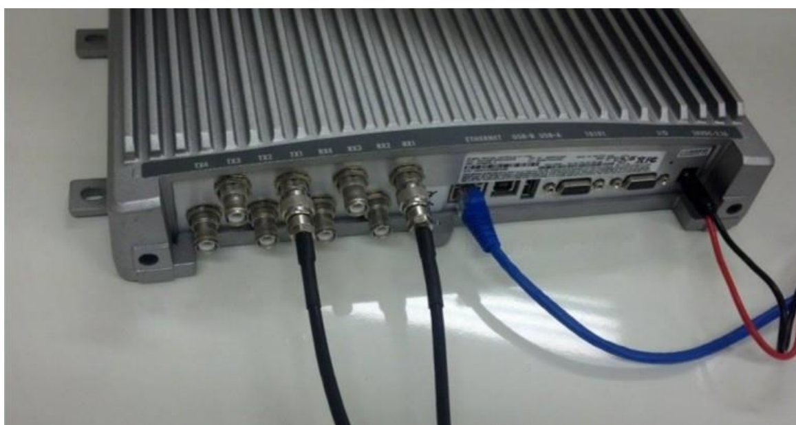
Figura 17 – Ligações dos cabos para a operação do leitor RFID utilizado. Fonte: Próprio Autor.
