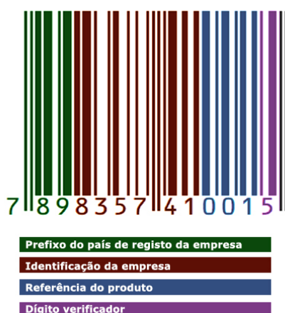
Figura 4 – Princípio de operação de um sistema com código de barras. Fonte: MARS (2014).
