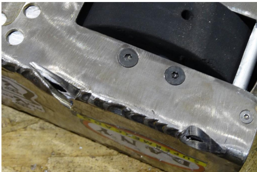
Figura 28 – Danos causados na carcaça devido a armas ativas
