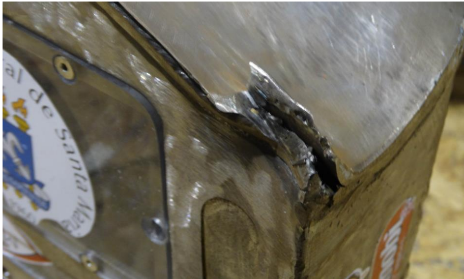
Figura 27 – Danos causados na carcaça por choques mecânicos
