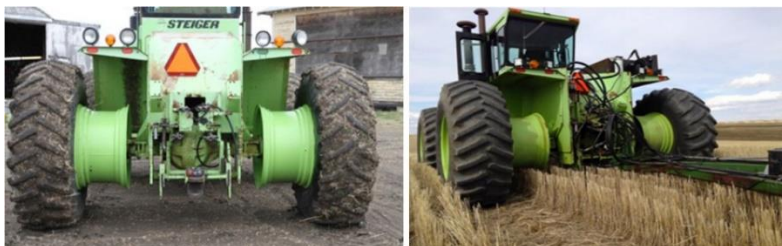
Figura 6 Adaptação realizada para que se obtenha a mesma bitola dos demais equipamentos utilizados no sistema de tráfego controlado. Foto: Larocque, 2015.
