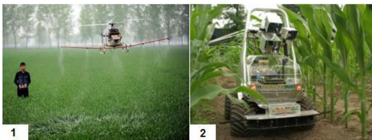
Figura 22 VANT em pulverização (1), robô com plataforma com múltiplos sensores (2). Fonte: Foto publicada no Canaltech (1). Foto Dr. ir. Ard Nieuwenhuizen (2).
