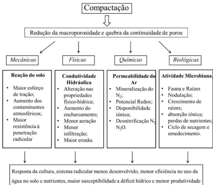
Figura 2 Esquema representativo da influência da compactação nas funções desempenhadas pelo solo. Fonte: Adaptado de Boone (1986).
