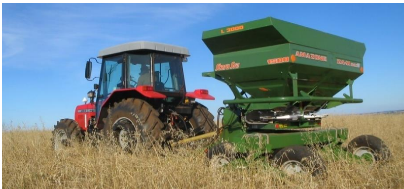
Figura 2 Conjunto utilizado para aplicação de fertilizantes a taxa variada. Trator MF 5310 com sistema Fieldstar e Distribuidor ZAM 1500 Amazon - Stara Sfil.
