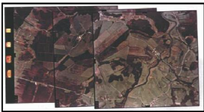
Figura 7 Sequências de fotografias sobrepostas realizadas em um voo fotogramétrico. Fonte: Fontes, (2005).
