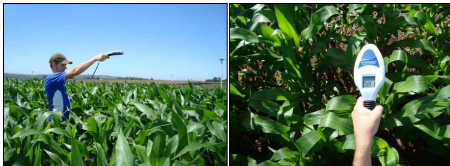
Figura 2 Leituras para a obtenção do Índice de vegetação por diferença normalizada (NDVI) com o sensor óptico Greenseeker no estágio fenológico V7 da cultura do milho.
