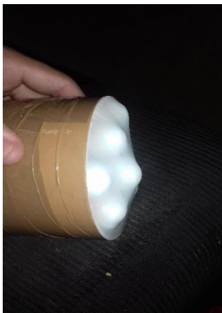
Figura 8 – Parede elástica com protuberâncias causadas pelas bolinhas de isopor
