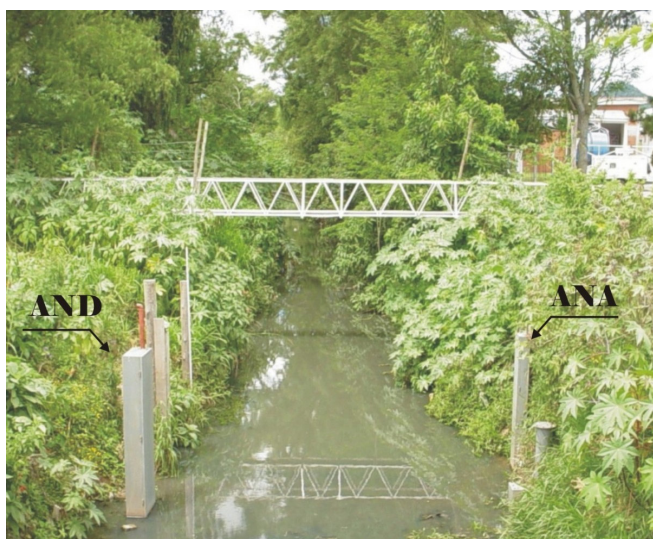
Figura 6. Foto da Estação Fluviométrica Cancela, onde estão instalados os amostradores de nível, ANA e AND, indicados na foto.
