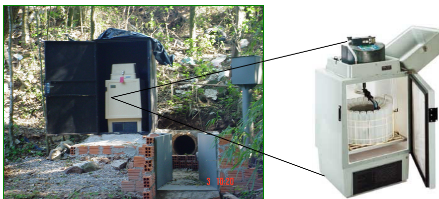
Figura 4.9 - Amostrador ISCO modelo FR7600 instalado na estação hidrossedimentométrica.
