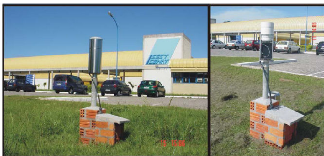
Figura 4.2 – Estação pluviográfica Sest Senat. Fonte: Garcia (2005).
