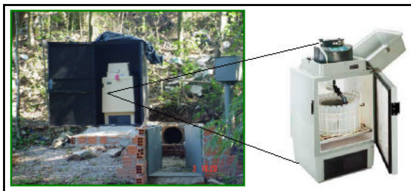
Figura 5. 4 – Amostrador ISCO modelo FR7600 instalado na estação hidrossedimentométrica. Fonte: Dotto, 2006.
