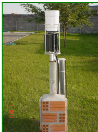
Figura 4. 4 – Pluviômetro eletrônico do tipo Pluvio OTT. Fonte: Dotto, 2006.
