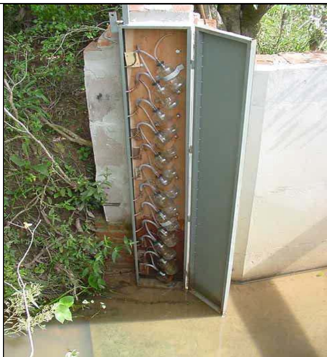
FIGURA 03 - Amostrador de nível ascendente ANA instalado na estação Alto da Colina II.
