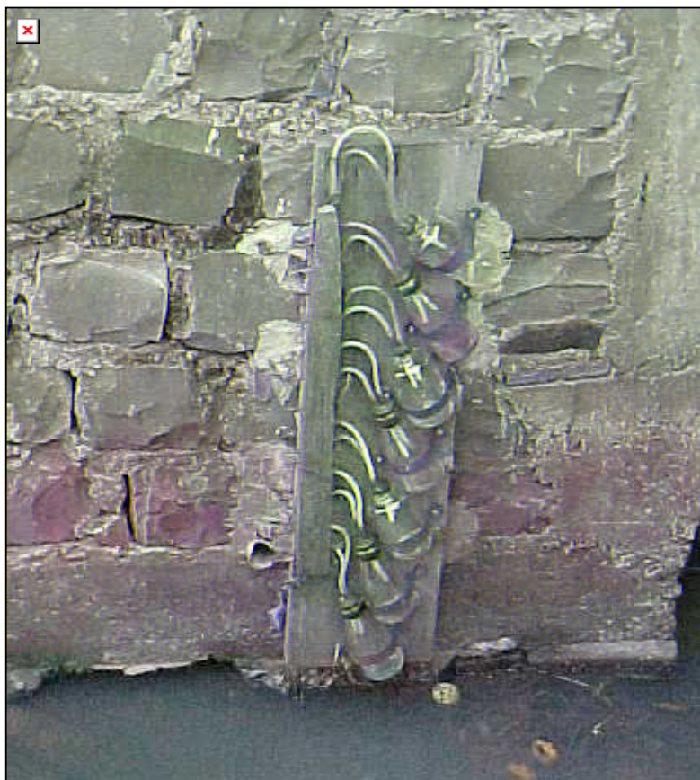
Figura 2. Amostrador de sedimentos em suspensão de nível ascendente automático ANA.
